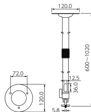
●金具取付の際は、下地材が十分な強度であることを確認し取り付けてください。
