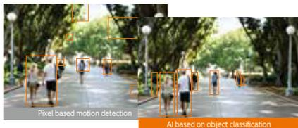
ディープラーニングテクノロジーに基づく誤動作の削減。人物、車両のみの動きを検出して、木や影、動物など無関係な情報による誤動作を削減し効率を向上。
