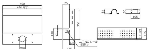
●金具取付の際は、下地材が十分な強度であることを確認し取り付けてください。
