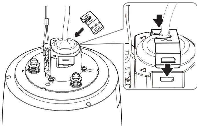
6. マウント上面の固定用ネジ3個をしっかり締めてください。
