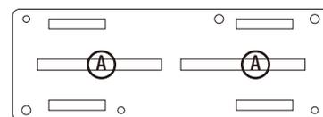
2. ②BOX型ダミーカメラ底部のネジ穴と、 ④カメラ固定ネジで、③どちらかのベース(A)に取付けます。本体レールに、③ベースを貼りつけベースの6ヶのいずれかの穴に、⑤つや消しのベース固定ネジでレールと固定します。
