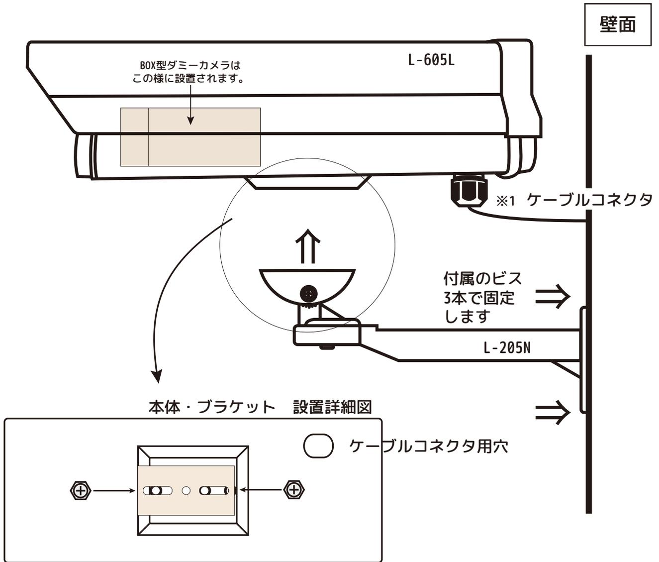
1. ①屋外用ハウジング-L-605L（以下本体）を逆さに置き、壁面ブラケット（L-205N）をブラケット取付ビスで2ヶ所とめます。
