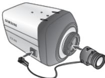
5. 自動レンズ用ケーブルに接続されているコネクタプラグを、カメラの側面にある自動絞りレンズ用コネクタに差し込みます。
