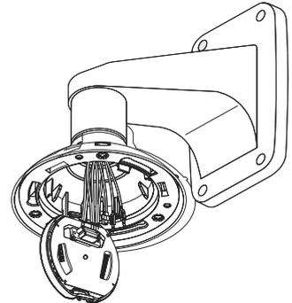
3. カメラの安全ワイヤーを設置ベースに接続します。
