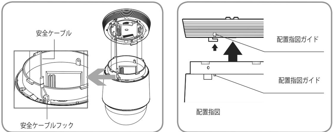
\* カメラをマウントに取り付ける際には、図に示されている取付け方向のガイドマークに従ってください。
