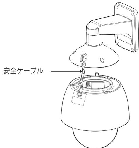
4. カメラと設置ベースの組立て 取付け方向ガイドを合わせて、設置ベースとカメラを組み立てます。
