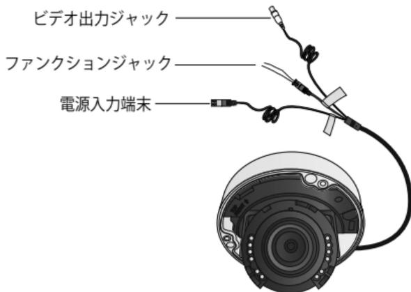
3. “カメラの監視方向の調整” セクションを参照してレンズを目的の方向に調整します。
